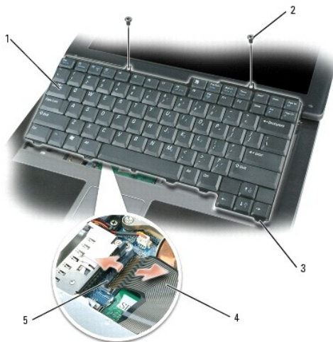
1 鍵盤 2 鍵盤螺絲 3 彈片 (5) 4 鍵盤纜線 5 鍵盤連接器上的塑膠杆
